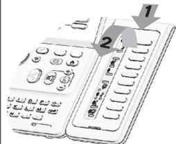
Ihr Telefon kann mit einem Erweiterungsmodul versehen werden. Es verfügt damit über zusätzliche als Funktionstasten, Leitungstasten, Kurzwahlstasten konfigurierbare Tasten usw.
